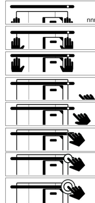
nnn = nombre progressif de cycles de soudure et coupe réalisés
