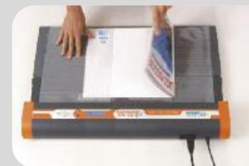
**2** Placer la couverture CoLibri dans la fissure et appuyer sur **START**: **e-DaVinci** actionne les capteurs, elle s'abaisse, coupe et soude automatiquement.
